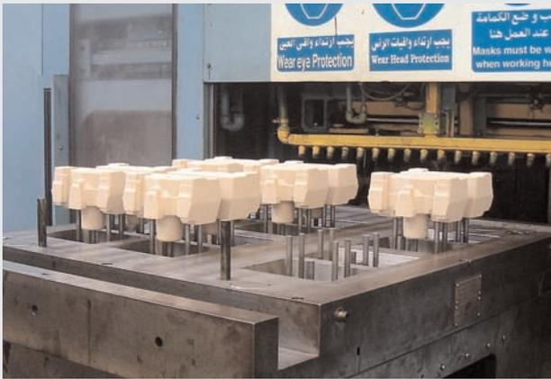
Die guten Harzverstreichungseigenschaften ermöglichen die Produktion hoher Kernstückzahlen bei reduzierter Reinigungszeit für Modelle.
